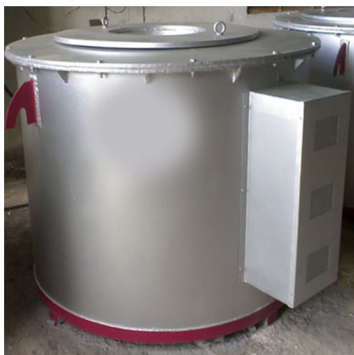
Фиг. 4.8.1-2 Електрическа тиглова печ
